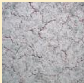
Une finition appliquée par une température trop forte
